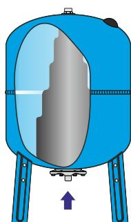
Una volta connesso al circuito a cui è destinato, la pompa parte facendo aumentare la pressione dell'impianto, facendo entrare l'acqua nella membrana.
