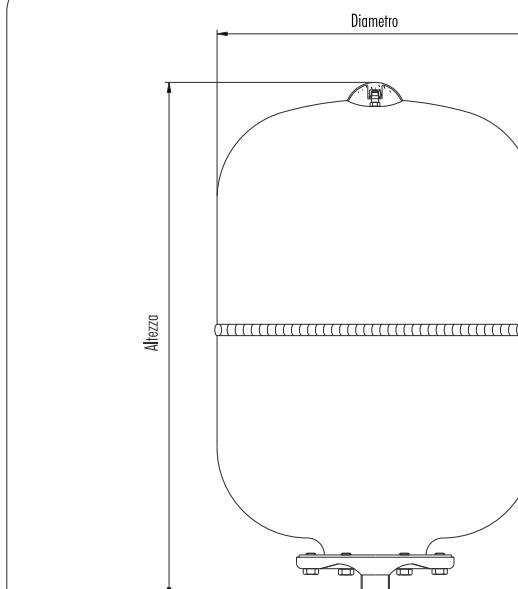
**Utilizzo:** Vasi di espansione con membrana intercambiabile per circuiti chiusi di riscaldamento.
