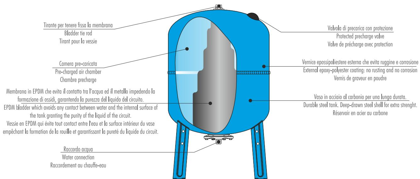
Tutti i vasi "acqua fredda" escono dalla fabbrica controllati, verificati e certificati. La membrana intercambiabile evita qualunque contatto tra aria ed acqua impedendo ogni possibile perdita di pressione, contaminazione e corrosione.
