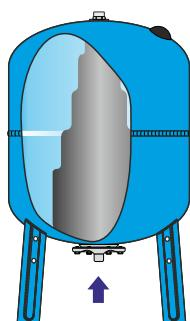
Si prosegue con l'erogazione di acqua all'impianto, la membrana si sgonfia, sino al raggiungimento della pressione di soglia minima dell'impianto. A questo punto, la membrana è ritornata alle dimensioni iniziali, la pompa si riavvia ed il ciclo si ripete. Poiché la gamma "acqua fredda" garantiscono in ogni istante la massima quantità di acqua possibile, le potenze della pompa sono ridotte al minimo.
