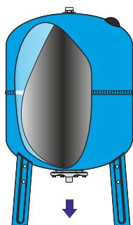
Quando la pressione dell'impianto raggiunge il valore di soglia massima impostata la pompa si arresta. Nel vaso vi è la quantità massima d'acqua accumulabile. Naturalmente la membrana si è dilatata ed occupa la quasi totalità del volume interno del vaso. Se richiamata dall'impianto l'acqua comincia ad uscire senza l'ausilio della pompa sfruttando la pressione dell'aria della camera pressurizzata.
