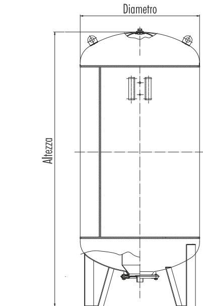
**Utilizzo:** Vasi di espansione con membrana intercambiabile per circuiti chiusi di riscaldamento.
