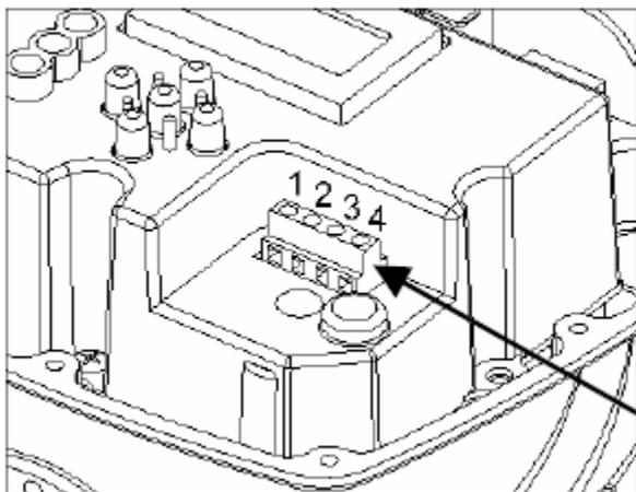
Устройство *Sirio Entry 230* оснащено специальным соединителем вспомогательного контакта, что позволяет использовать дополнительные функции при сопряжении устройства с внешним оборудованием. Функция вспомогательного контакта зависит от настройки параметра «Auxiliary Contact» («Вспомогательный контакт»), описанного в параграфе по программированию. Три рабочих режима, соответствующие функции и методы соединения описаны ниже.
