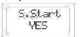
**Плавный пуск:** Этот параметр может быть включенным или выключенным. Если он включен, насос плавно набирает обороты, в противном случае, насос за 1 секунду набирает максимальную скорость вращения вала, и лишь затем начинает подстраивать скорость вращения вала электродвигателя под нужды потребителя.
