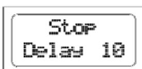
**Задержка остановки:** используйте данный параметр для установки количества секунд, через которое должен остановиться насос после прекращения потребления воды. Если при медленных потоках воды насос постоянно включается и выключается, увеличьте задержку отключения, чтобы обеспечить более плавную работу насоса. Увеличение параметра применяется также для предотвращения частого запуска устройства защиты от работы всухую, особенно в тех случаях, когда используются
