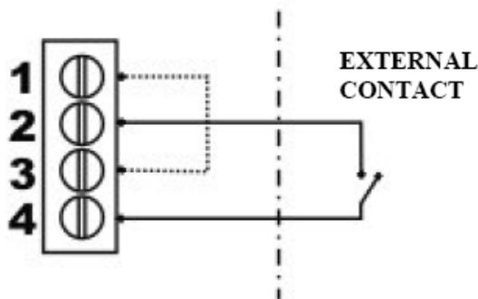
*Entry 230* должно регулировать вращение насоса согласно значению давления  $P_{max}$ , а если внешний контакт замкнут, устройство должно регулировать скорость работы насоса соответственно значению  $P_{max2}$ .
