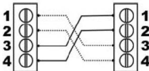
не нужно. С другой стороны, если устройство *Sirio Entry 230* подсоединено к другому блоку для создания группы регулировки давления, монтаж проводов необходимо выполнить в соответствии со схемой, показанной сбоку; дополнительная информация о работе устройства как части сдвоенных блоков регулировки давления представлена в разделе «БЛОКИ РЕГУЛИРОВКИ ДАВЛЕНИЯ» в приложении.
