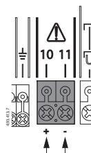
Подключение насоса с постоянной скоростью к линии электропитания должно выполняться через двухполюсный магнитный выключатель соответствующего размера.
