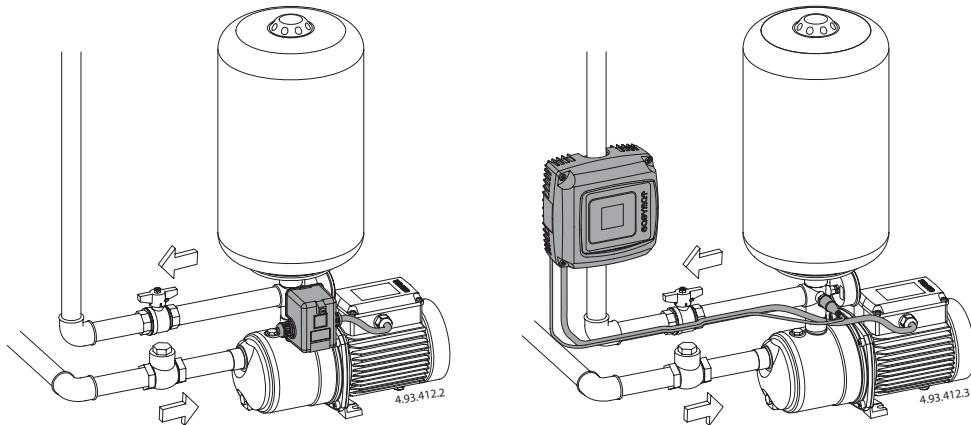
**22. Schema installazione pompa**
